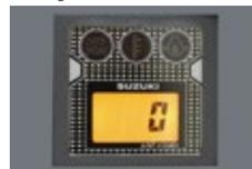
Drehzahlmesser mit Warnleuchten
